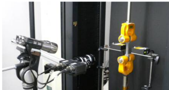
図4-1 定ひずみ速度引張試験セットアップ
