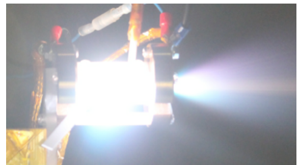
Fig 1.4 螺旋供給式 PPT 作動時の様子 及び供給口と排出口からリークした PTFE ガス
