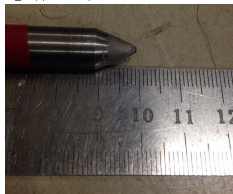
図25 噴射後のロッドカソード
