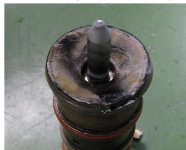
図20 実験後のロッドカソード
