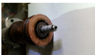
図27 噴射後のシングルホローカソード
