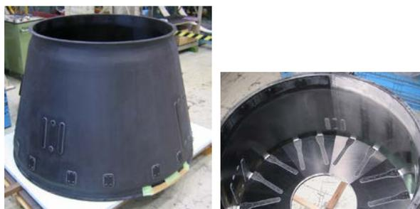
図10 CFRPハニカムサンドイッチ構造の試作結果
