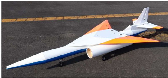
図 2 2. 試作された第一世代実験機の縮小機体 (M2006 プロトタイプ形状、縮小比 1/2)
