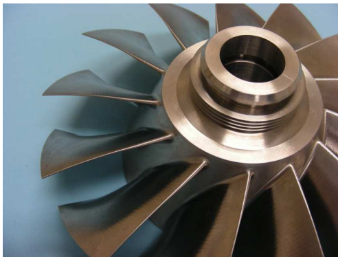
(d) 試作された1段階ファン
