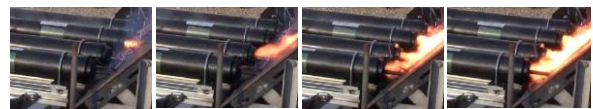
図1 ハイブリッドロケット着火のばらつき (左から右まで 0.5 秒の遅れ)
