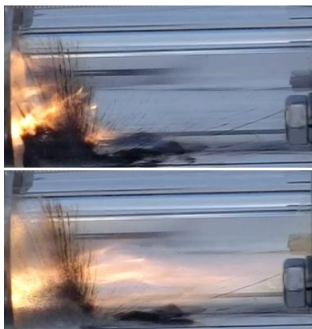
図 8 低引火点グリスを塗布した場合の t=0.1s における内面キャプチャ画像。
