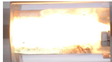
図 10 低引火点グリスを塗布した場合の t=0.1s における内面キャプチャ画像
