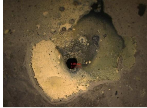
Fig.3-11 HAN(SHP163)系分解ガス噴射後のコンバージェントノズル
