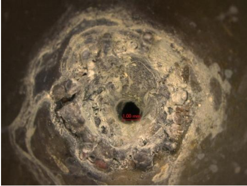
Fig.3-10 HAN(SHP163)系分解ガス噴射後のダイバージェントノズル損耗
