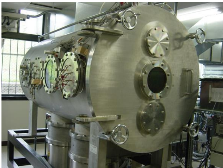
図 2 真空チャンバー外観図
