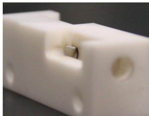
Fig 4.1 螺旋供給式キャビティに生じた炭化の跡
