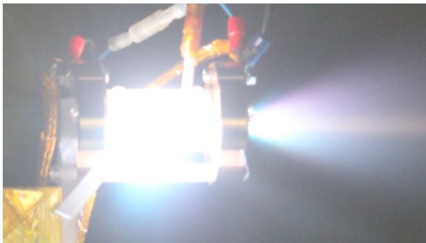
Fig 3.2 螺旋供給式 PPT 作動時の様子
