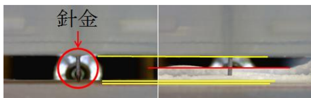
図12 霜層の測定方法
