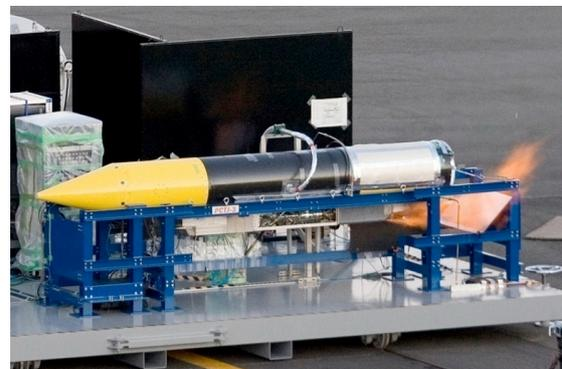
図 2 予冷ターボジェットエンジンの燃焼試験
