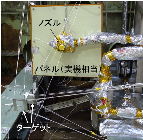
図11 真空チャンバ内の機器配置
