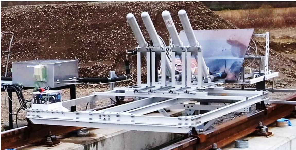
図2 ロケットスレッド台車（RS-702:全長2030 mm、幅1590 mm、重量72 kg）向かって左前部に取り付けられている透明防水ケースの中に測定機器類が収められている。奥に見えるSUS製箱は亜酸化窒素充填のための地上側電磁弁・計測機器BOXで、恒常的に設置されている。
