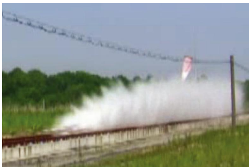
図9 減速水路に時速 350km で突入する走行スレッド
