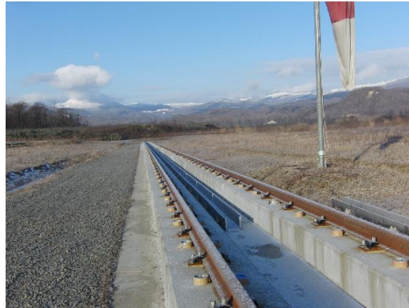
図1 高速走行軌道実験設備（全長 300 m、軌道幅 1.435 m）
