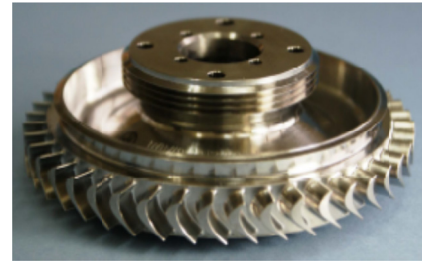
(d) 試作された 1 段目タービンプリスク
