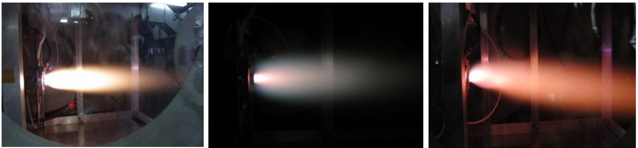
Fig.4-1 SHP163分解ガス・ヒドラジン模擬ガス・窒素のみ其々の噴射
