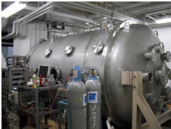
図5. 円筒形大型真空チャンバ
