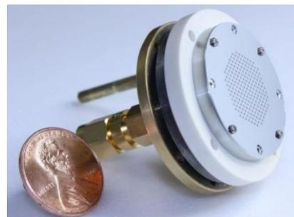
Fig. 3 Miniature Microwave Discharge Ion Thruster ( $\mu\text{l}$ ).
