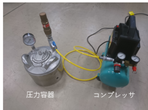
図 8：耐水圧試験のセットアップ
