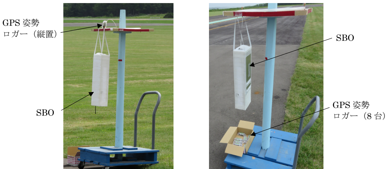
図 9：EMC 試験の様子（左：気球尾部配置 1 台試験 右：パラシュート頭部配置 8 台試験）
