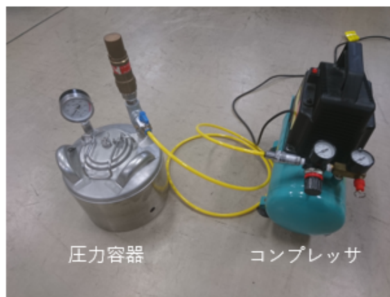
図 8：耐水圧試験のセットアップ
