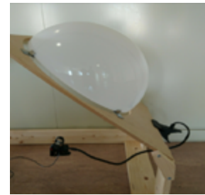
図5 フランジ無しアクリル半球の4点支持, およびフレキシブルアームを用いた赤外線 Web カメラの支持を示す.
