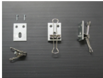
図4 ダブルクリップを用いた着脱式のアクリル半球の支持具.
