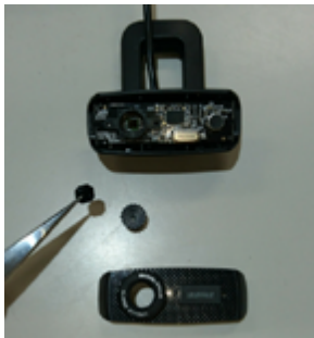
図7 適切なサイズに切断した IR フィルターを，CMOS センサ前に組み込む様子を示す．マスク用の 3φ のワッシャーも同様に組み込む．
