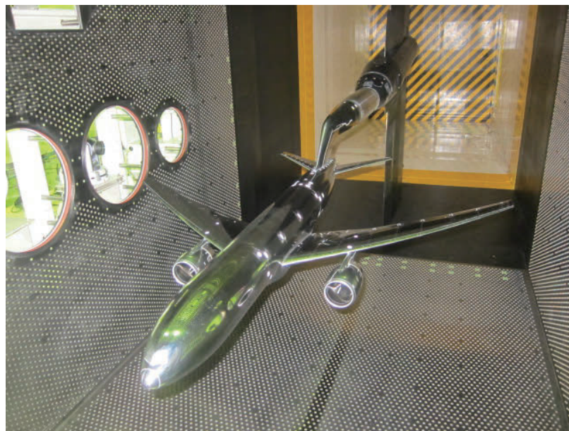
Fig. 3-2 ナセルあり形態の 80%縮尺 NASA Common Research Model
