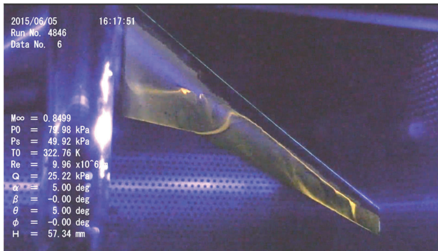
(b) Toe-In (VGToe-InDvHv40) 迎角 5.47^\circ (設定迎角 5.0^\circ )
