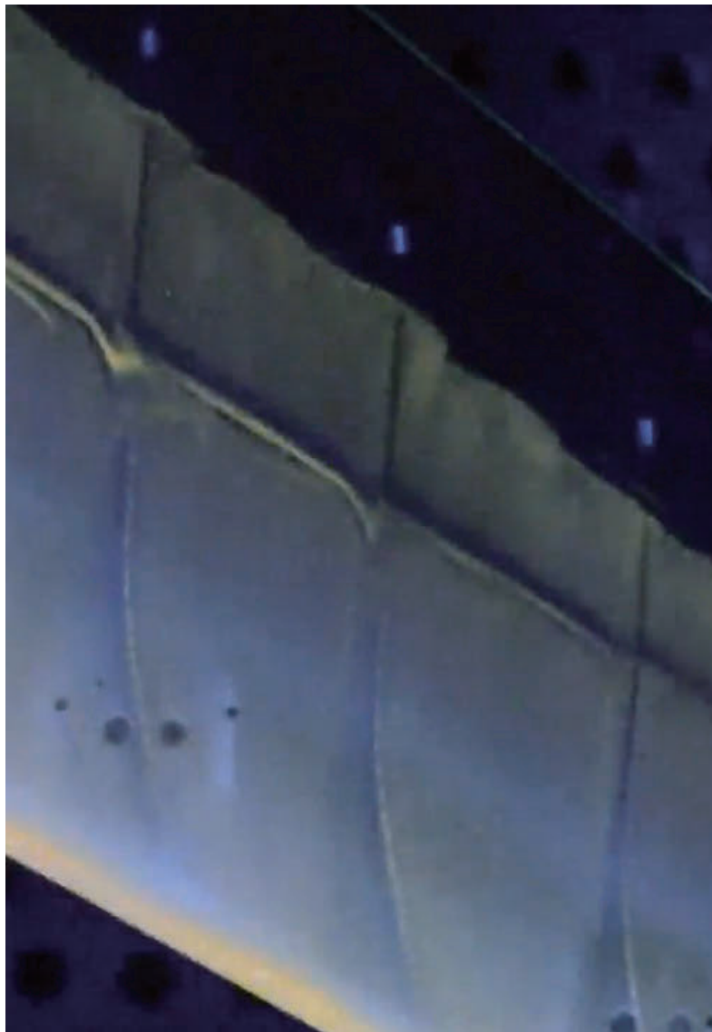
Fig. D-2-4 ナセルなし形態における VG の向き Toe-In (VGToe-InDvHv40)のオイルフロー拡大図. 迎角 2.82^\circ (設定迎角 2.5^\circ ).
