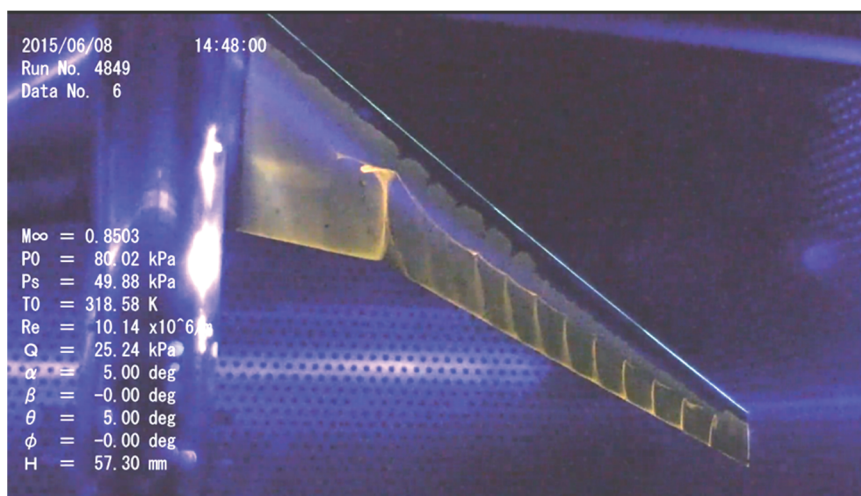
(c) Toe-Out (VGToe-OutDvHv40) 迎角 5.44^\circ (設定迎角 5.0^\circ )
