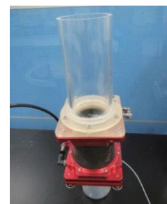
図1 セグメント 収縮実験装置
