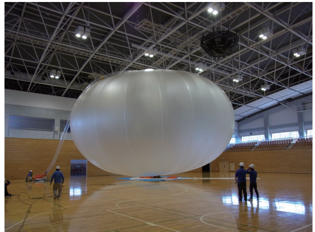
図 13 破壊直前の気球 (1,000 Pa)
