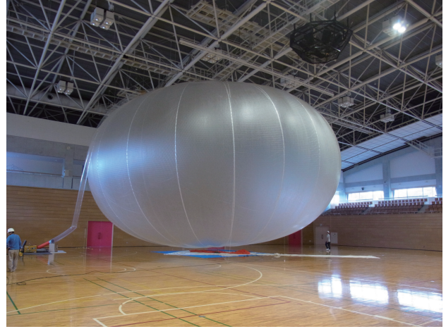
図 11 満膨張の気球 (200 Pa)
