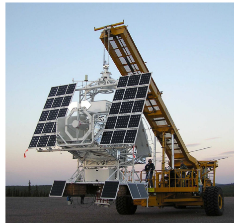
図1: SUNRISE ゴンドラと口径1m望遠鏡
