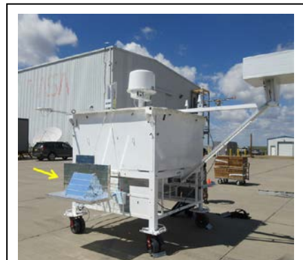
図 4. B18-04 に搭載予定だったラジエータの写真と熱モデル
