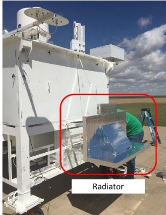
図2 SIFT ギンドラに搭載されたラジエータ
