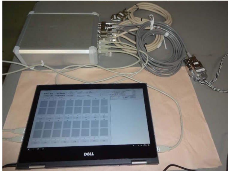
図 5 テレメトリ・コマンド環境模擬装置、右側の白黒線の先に PI-IF が接続される
