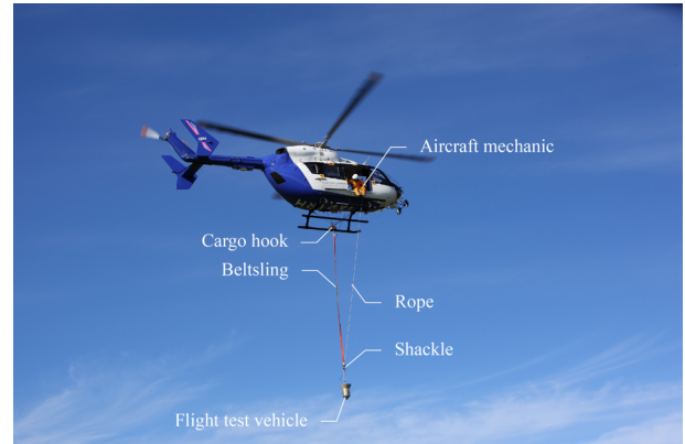
図 6 超音速パラシュートを搭載した供試体を懸架したヘリコプター
