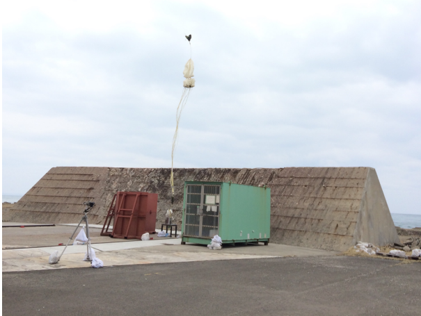
図 4 能代ロケット実験場で行われた超音速パラシュート地上放出試験
