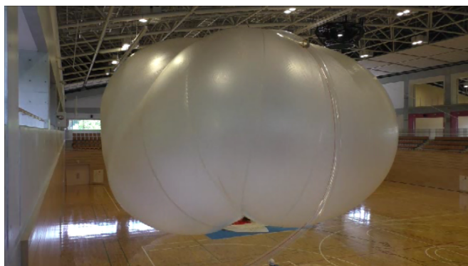
図 5: NPB2-2 気球の破壊時
