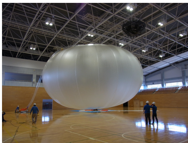
図 4: 1,000 Pa 印加時の NPB2-2 気球
