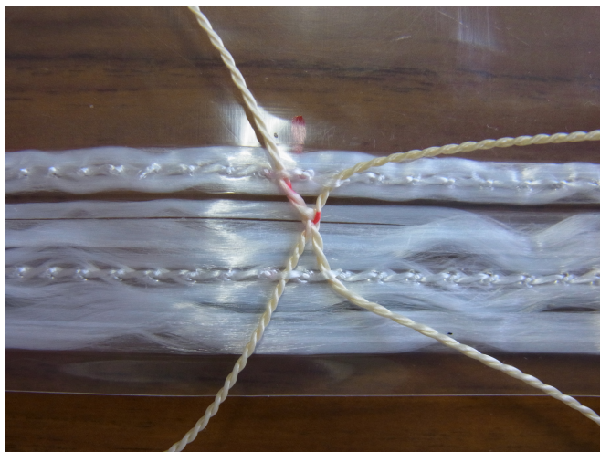
図 1: 二列直線縫いによる網の固定。
