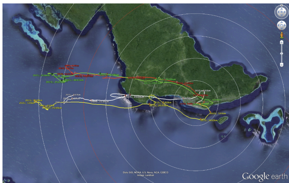
図 13 気球飛翔航跡 JTBK-A、B、C 及び D の航跡をそれぞれ赤、白、黄色、緑線で示している。 同心円の間隔は 10 km であり、同心円中心が放球点を示す。
