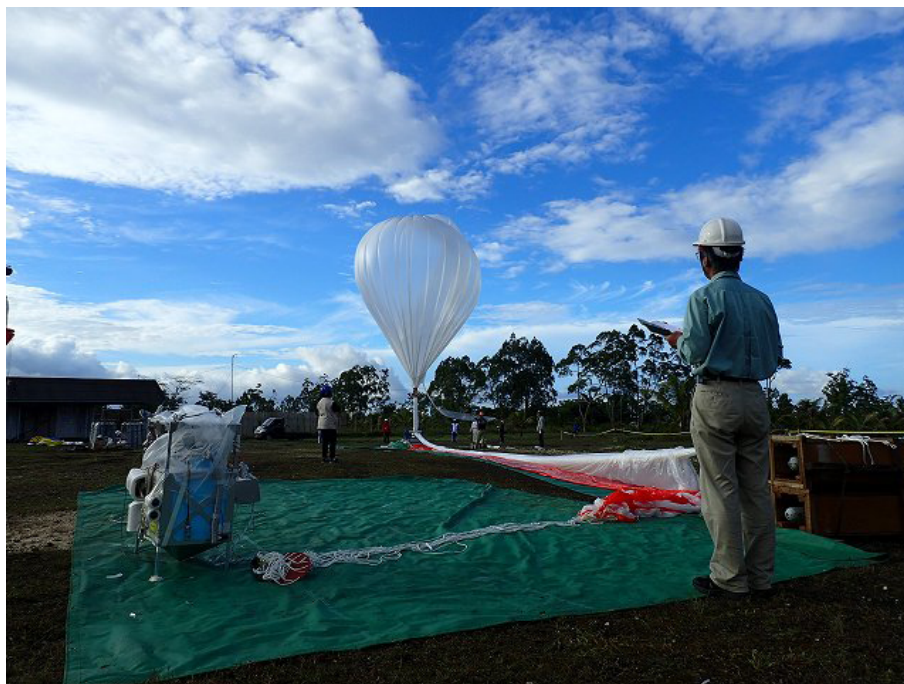
図 11 放球直前の様子 アンカーとして利用したシリンダが右側に写っている。
