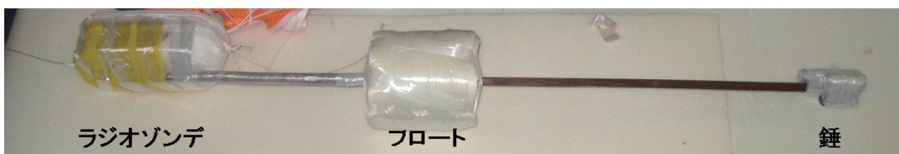
図 7 回収リハーサルで使用した防水ゾンデの外観
