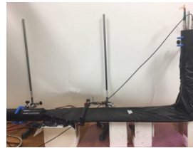
図 5 ストレート型(左端)とカーブ型(右端)のライトガイドを取り付けた試作 TOF カウンタ [8][9]
