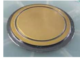
図 5: 2 inch Si(Li)素子へ設けたガードリング (円形の溝)
