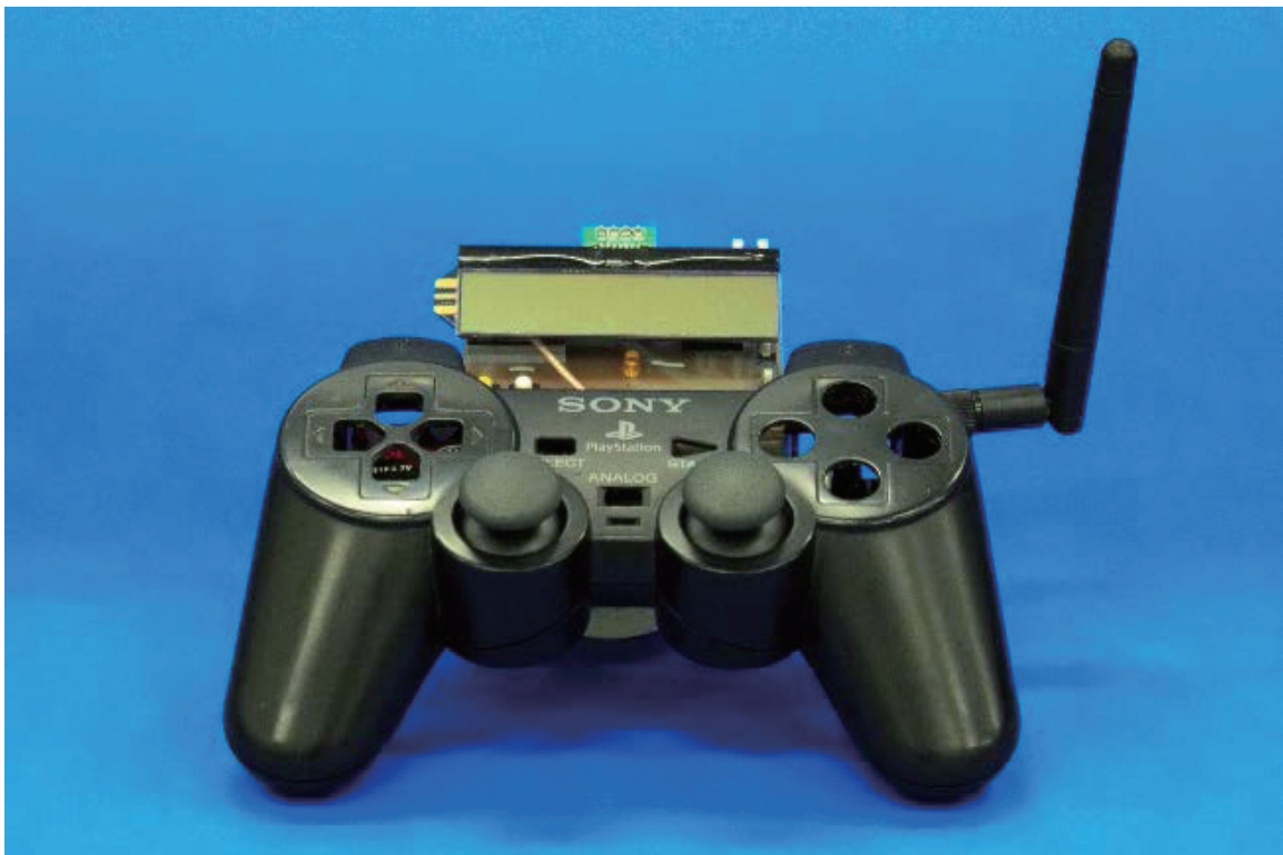
図 8 市販ゲーム機の筐体を使用した地上側制御用コントローラー
