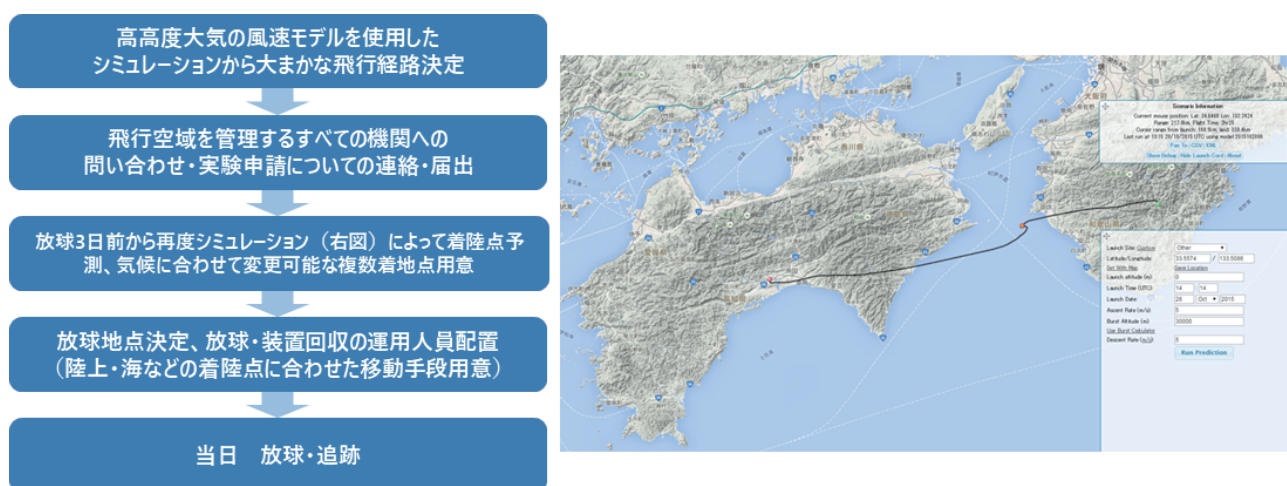
図 1 （左）国内における超小型気球の運用フローおよび（右）高層大気風モデルを利用した飛行シミュレータ [4]
