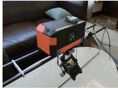
図 4 米国海軍研究所が開発中の姿勢制御付帯小型太陽電池高空測定装置.
