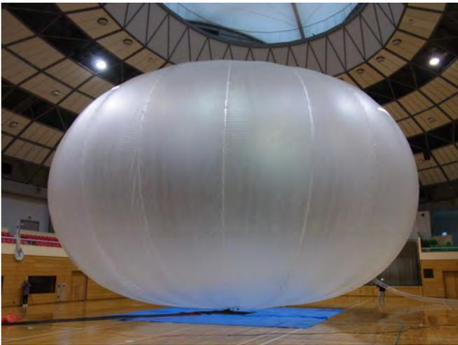
図 3: NPB2-1 気球の 200 Pa 印加時。
