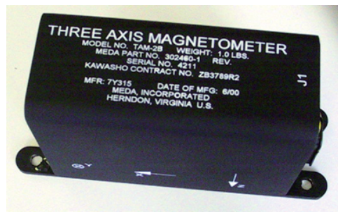
図1：れいめい衛星搭載磁力計（GAS）
