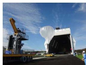
写真6 スプール開放
