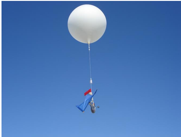
Fig.1 虹ノ松原における気球浮揚電動無人機実験 (2008年11月14日)
