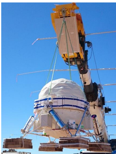
図 1. GRAINE-2015 ゴンドラ荷姿. 66 cm 長の塩ビ製フードが 3 本取り付けられている。
