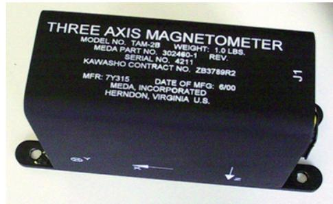
図1：れいめい衛星搭載磁力計（GAS）
