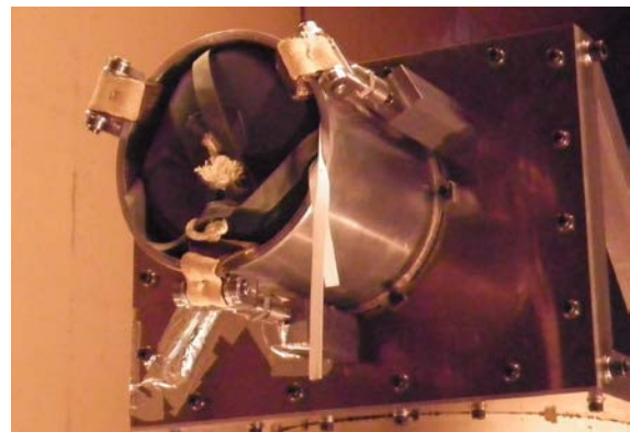
図6 低速風洞での放出試験におけるパラシュート収納管に搭載されたパラシュート
