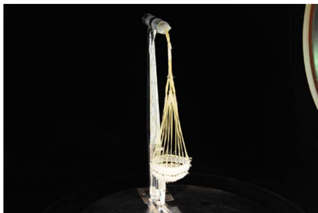
図 1 調布航空宇宙センター超音速風洞におけるパラシュート風洞模型(S-2)
