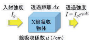
図 1 X 線吸収と CT 画像輝度との関係
