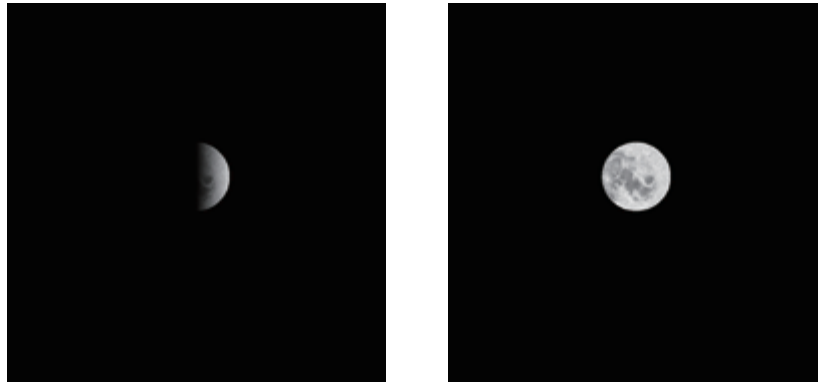
図 15 陰影効果を無視したシミュレーション例. 2007 年 11 月 14 日 06:36:00(UTC) に実施した Rosetta OSIRIS NAC による地球スイングバイ後の月観測を模擬している. 陰影あり (左) と陰影なし (右) をそれぞれシミュレートしている.
