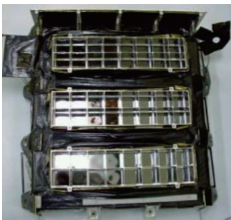
図 1 ARD 外観. Si 半導体素子 46 個で構成されており、全体で 326 \text{ cm}^2 の有効面積を持つ. 2 \times 8 個の素子をユニット (チャンネル) として、出力信号はチャンネルごとにまとめて処理される (写真上側よりチャンネル 1, 2, 3).
