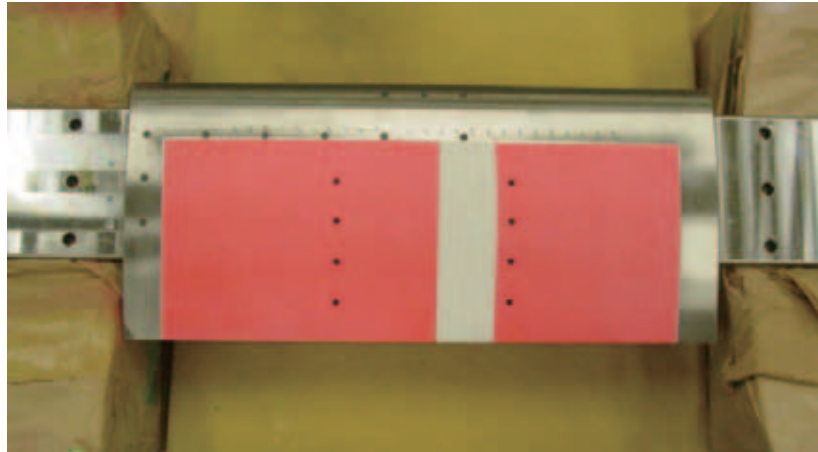
図 3-14 感圧塗料塗装を施された模型
