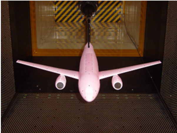
(a) PSP 塗装された風洞模型
