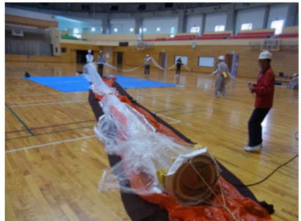
図 40 気球を引っ張りながら、He ガスを注入
