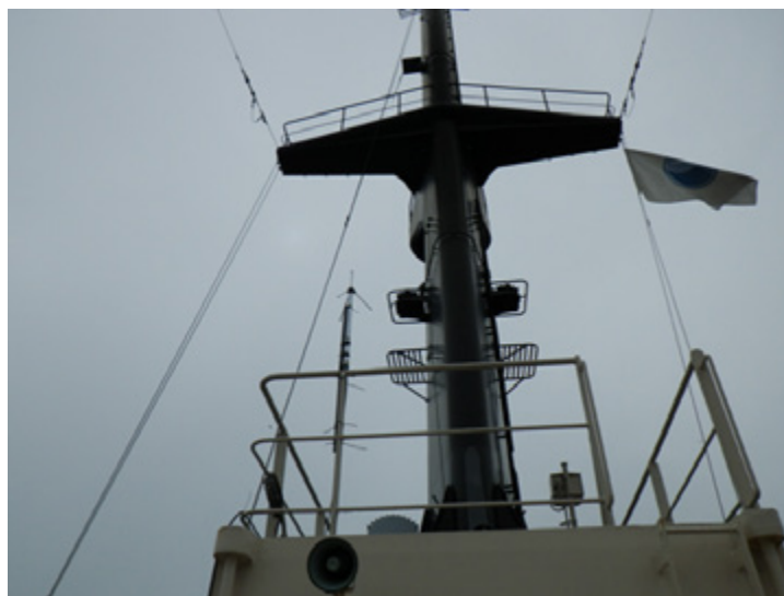
図3 白鳳丸メインマスト基部の手摺りに設置されたブラウンアンテナ。写真では支柱に塩化ビニールパイプを使用しているが、観測開始前に、より高強度で高剛性な木製棒に交換した。
