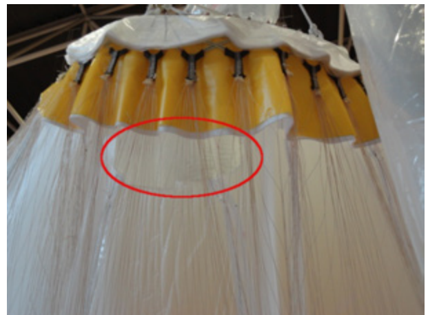
図 8 気球頭部の破壊箇所 (赤線内側)
