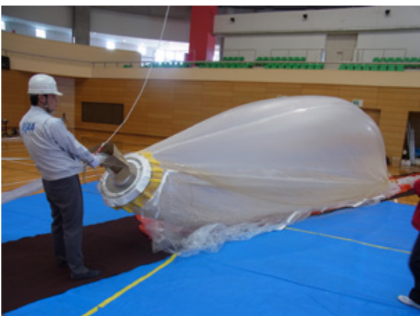
図 41 気球を引っ張りながら、He ガスを注入
