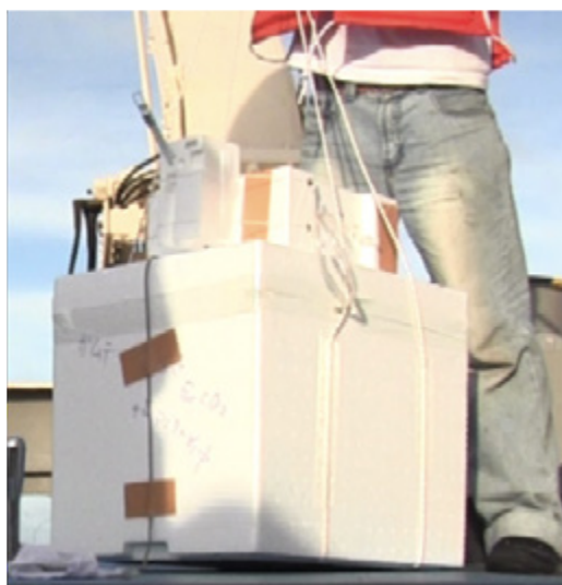
図9 放球直前のCO 2 ゾンデ。標準ガスコンテナ(下部の大きな発泡スチロール製箱)の上面にCO 2 ゾンデ本体とGPSゾンデが取付けられている。
