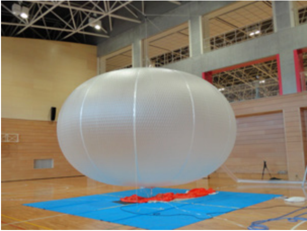
図 5 しわなく展開した気球 (800 Pa)
