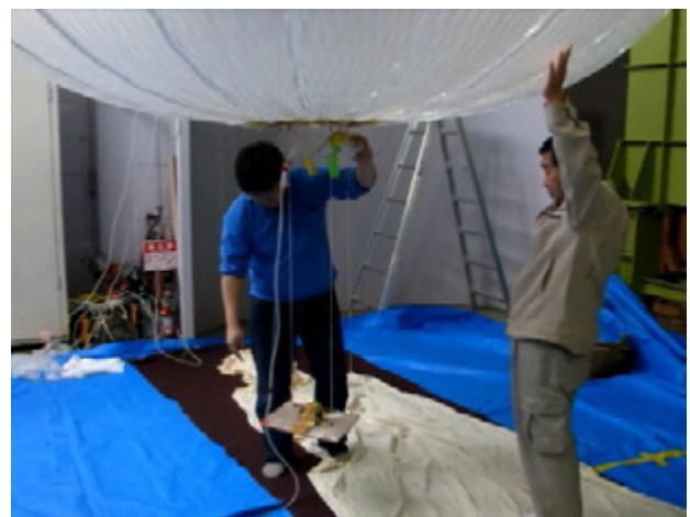
図 28 ゴンドラの吊り下げ方法の確認
