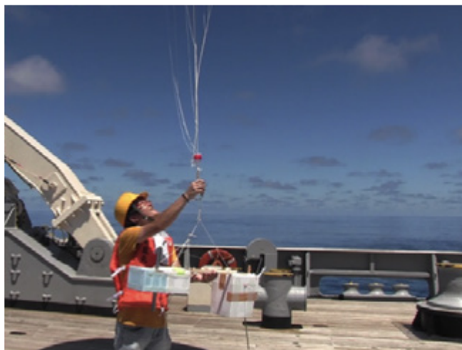
図8 CFH水蒸気ゾンデ+ ECCオゾンゾンデ+ GPSゾンデ放球直前の様子。放球は現地時間で2012年2月7日13時37分に行われた。
