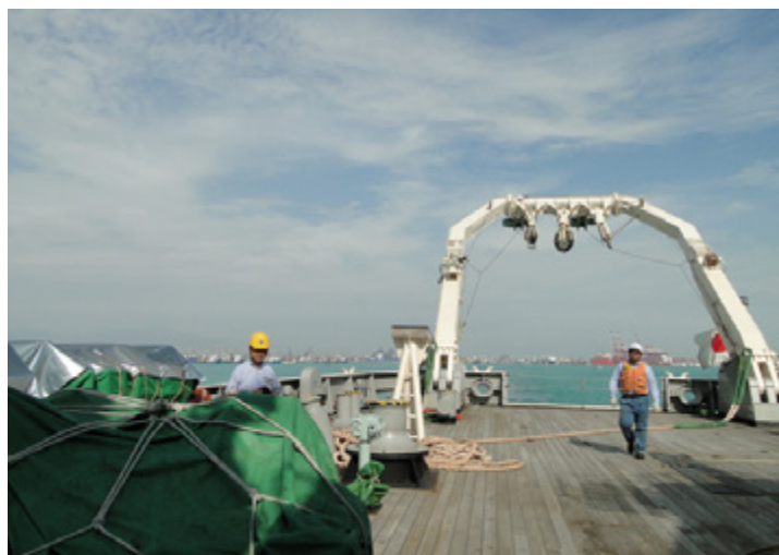
図4 ペルー、カヤオ港出港直後の「白鳳丸」後部甲板の様子。後部甲板船首側から船尾方向を撮影した。右舷側に設置されているのがヘリウムカードルであり、日射による昇温を軽減するため銀色の遮光シートが掛けられている。船尾の門型フレームは船尾方向に倒されている。
