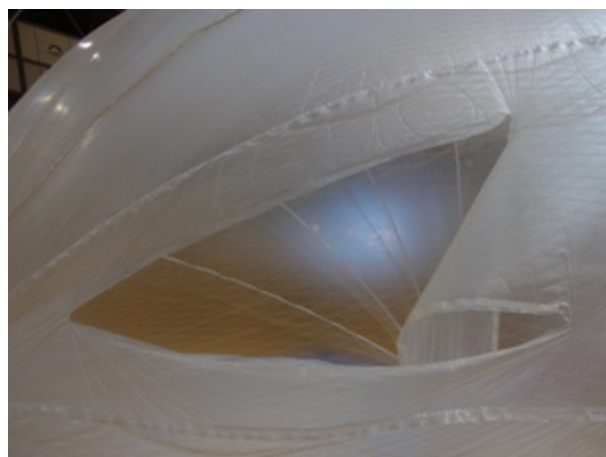
図 30 引き裂かれた気球
