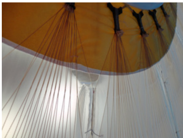
図 9 気球尾部の破壊箇所
