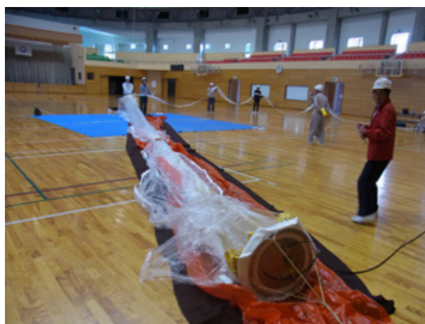
図 40 気球を引っ張りながら、He ガスを注入
