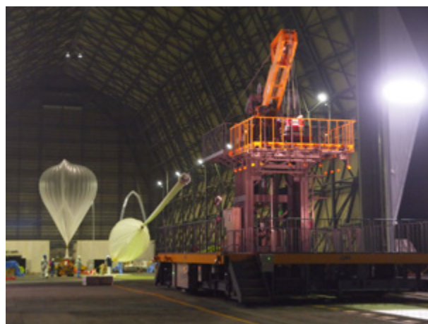
図 45 SP 気球へのガス詰め
