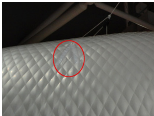
図 10 気球破裂後の引き裂き部 (赤線内側)
