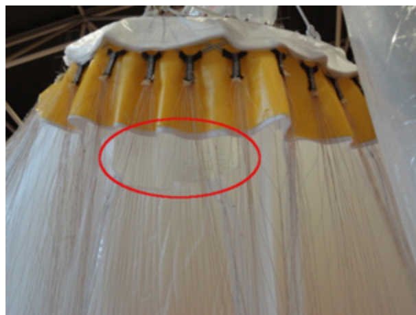
図 8 気球頭部の破壊箇所 (赤線内側)
