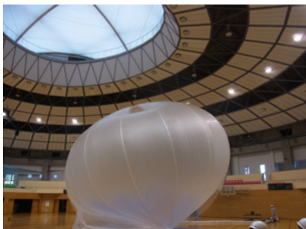
図 29 引き裂き機構が動作したところ
