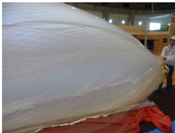
図 42 気球側面の網の垂れ下がり
