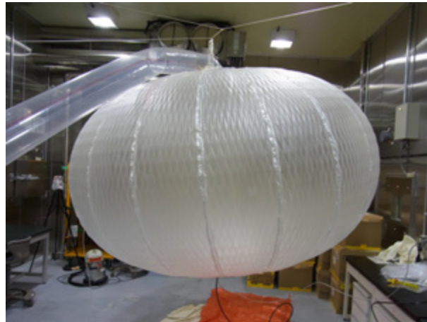
図14 -30\text{ }^{\circ}\text{C} の低温環境実験室で膨張させた気球
