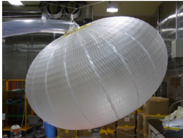
図 15 6,000 Pa 印加時の気球
