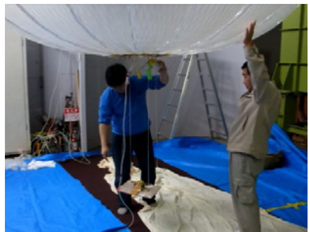
図28 ゴンドラの吊り下げ方法の確認
