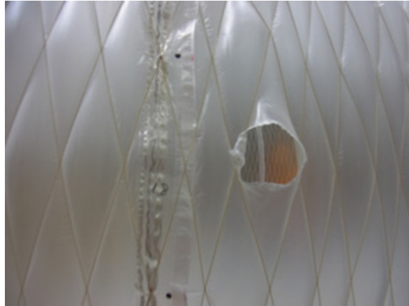
図 22 NPB001-4 気球の破壊箇所
