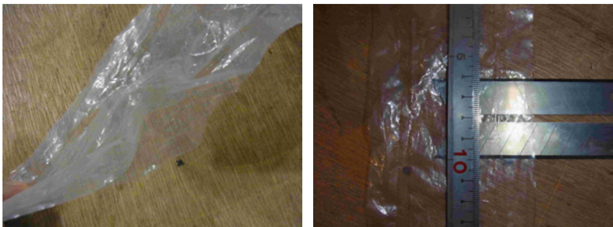
図 16 圧力計測ポートの破損箇所。左図中央の溶着部が剥離している。右図は剥離した溶着部にカッターの刃を挿入したところ。4 cm にわたる剥離が発生している。
