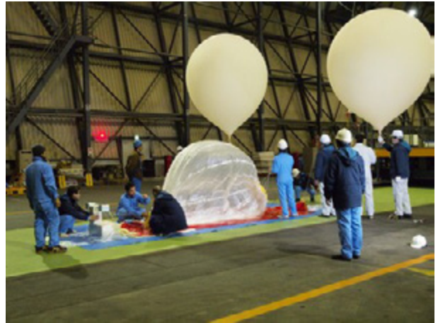
図 33 SP 気球とゴム気球の結合
