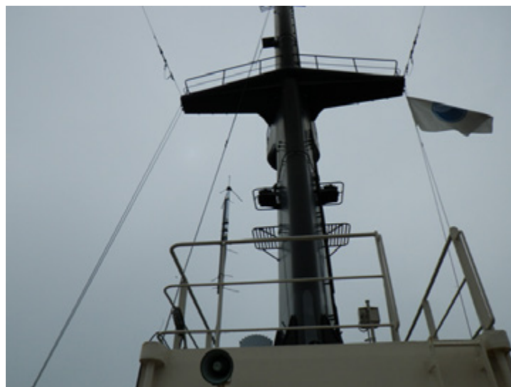
図3 白鳳丸メインマスト基部の手摺りに設置されたブラウンアンテナ。写真では支柱に塩化ビニールパイプを使用しているが、観測開始前に、より高強度で高剛性な木製棒に交換した。
