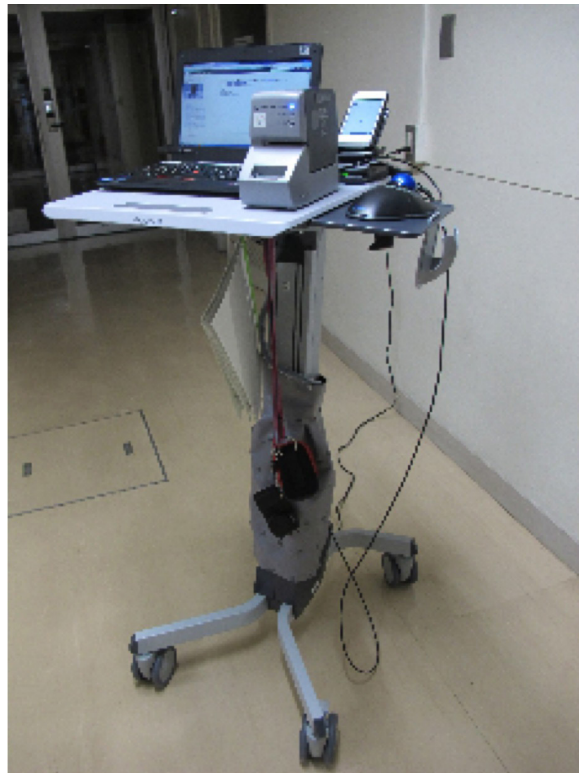
図 6 作業現場に配置される “DREAM 屋台” と呼ばれるポータブル作業環境：ラップトップコンピュータ、テーププリンタ、バーコードリーダー、カメラ、ハンドヘルドコンピュータから構成される。移動させて利用することが前提となるため、UPS で駆動する。
